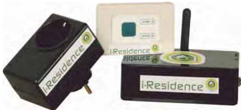
Alles drin: Im Standardpaket enthalten sind der Sturzsensoren, zwei Raummelder und der GSM- oder LAN-Sender – alles in einem praktischen Plastikoffen.
