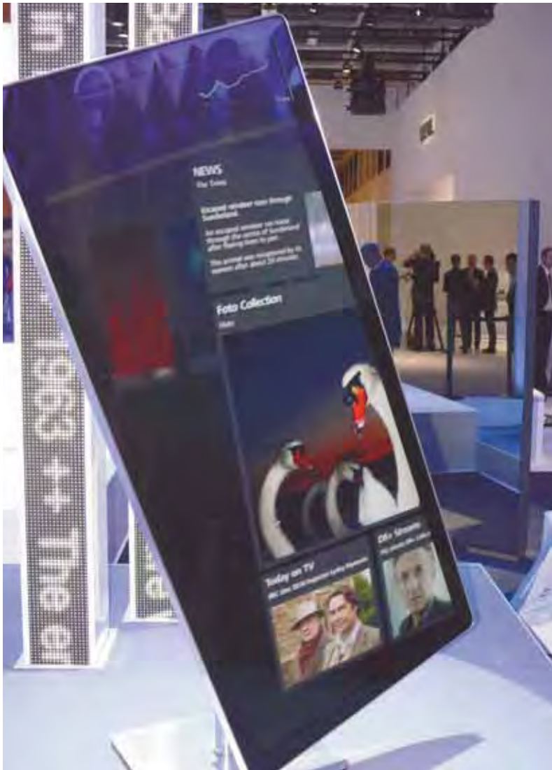
Bei der Loewe Pivot Designstudie schwenkt der Bildschirm je nach Nutzung: Als individualisierter Infoscreen präsentiert sich der Bildschirm im Hochformat. Filme werden am horizontalen Widescreen im 21:9-Format dargestellt.
