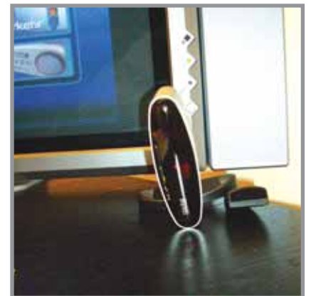
Gerade so groß wie ein Taschenbuch ist der Set Top-Receiver für den neuen aonDigital TV-Dienst der TA. Rechts daneben, der IR-Empfänger für die mitgelieferte Tastatur.
