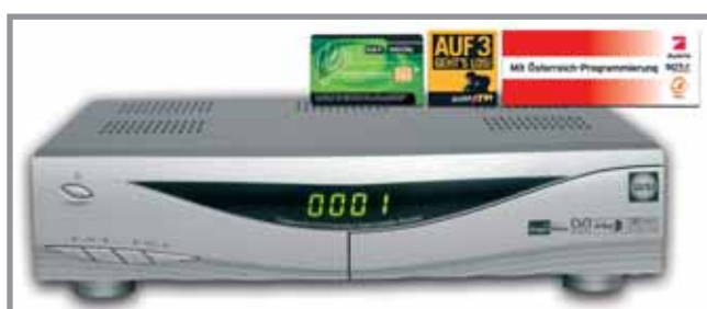
Das Wisi-Modell OR90A ist mit einem zusätzlichen S-VHS-Ausgang speziell für die Versorgung von Flat-TVs und Projektoren mit guten Bildern ausgelegt.
