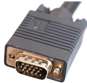
VGA-Signale werden über einen 15-poligen sog. D-SUB HD15 Steckverbinder übertragen
